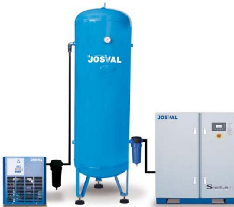
En caso de instalación completa de compresor con tratamiento de aire, el equipo constaría de compresor SILENTUM, separador ciclónico de condensados de la serie SCC, depósito acumulador, filtro separador de partículas de la serie FEP y secador frigorífico de la serie EDS con by-pass.
