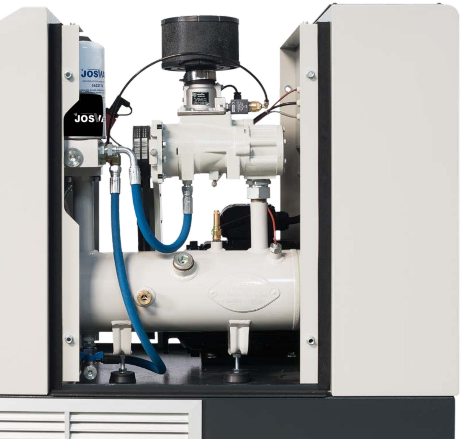
Los compresores rotativos de la serie MISTRAL, incorporan un bloque rotor de una etapa con tornillos asimétricos montados sobre rodamientos. Su accionamiento se realiza mediante un motor eléctrico trifásico asíncrono con protección IP 55/F-B, a través de correas trapezoidales. Este sistema de transmisión ofrece gran fiabilidad y bajo nivel sonoro.
