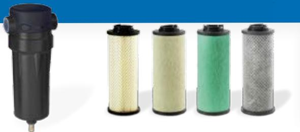
**FEP:** Filtros adecuados para la eliminación de partículas sólidas hasta 5 micras, incluidos líquidos, emulsiones y partículas de aceite. Su fuerte resistencia mecánica hace que estos filtros sean la protección inicial ideal para el principio de una instalación de aire comprimido y poder así retener las impurezas. Por ejemplo, se recomienda su instalación a la entrada de los secadores para hacer de prefiltro a los modelos FES.
